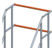
Garde-corps frontal si 2 garde-corps latéraux
