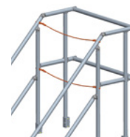
Câbles de sécurité
