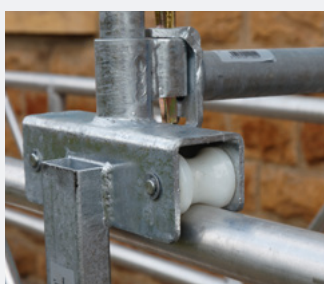
Chariot roulant modulable (adaptation à la largeur de travée souhaitée)
