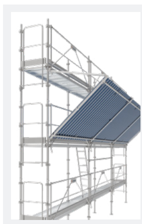
Echafaudage R200 à cadres R3 équipé d'une base Kombi
