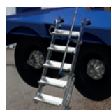
Fixation au plateau du camion par des aimants de force 85 kg
