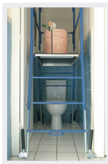
Béquille arrière permettant d'enjamber des obstacles (ex : WC)
