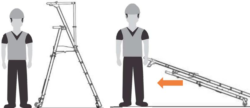
En position ouverte, le produit doit être déplacé sur les 4 roulettes escamotables.
