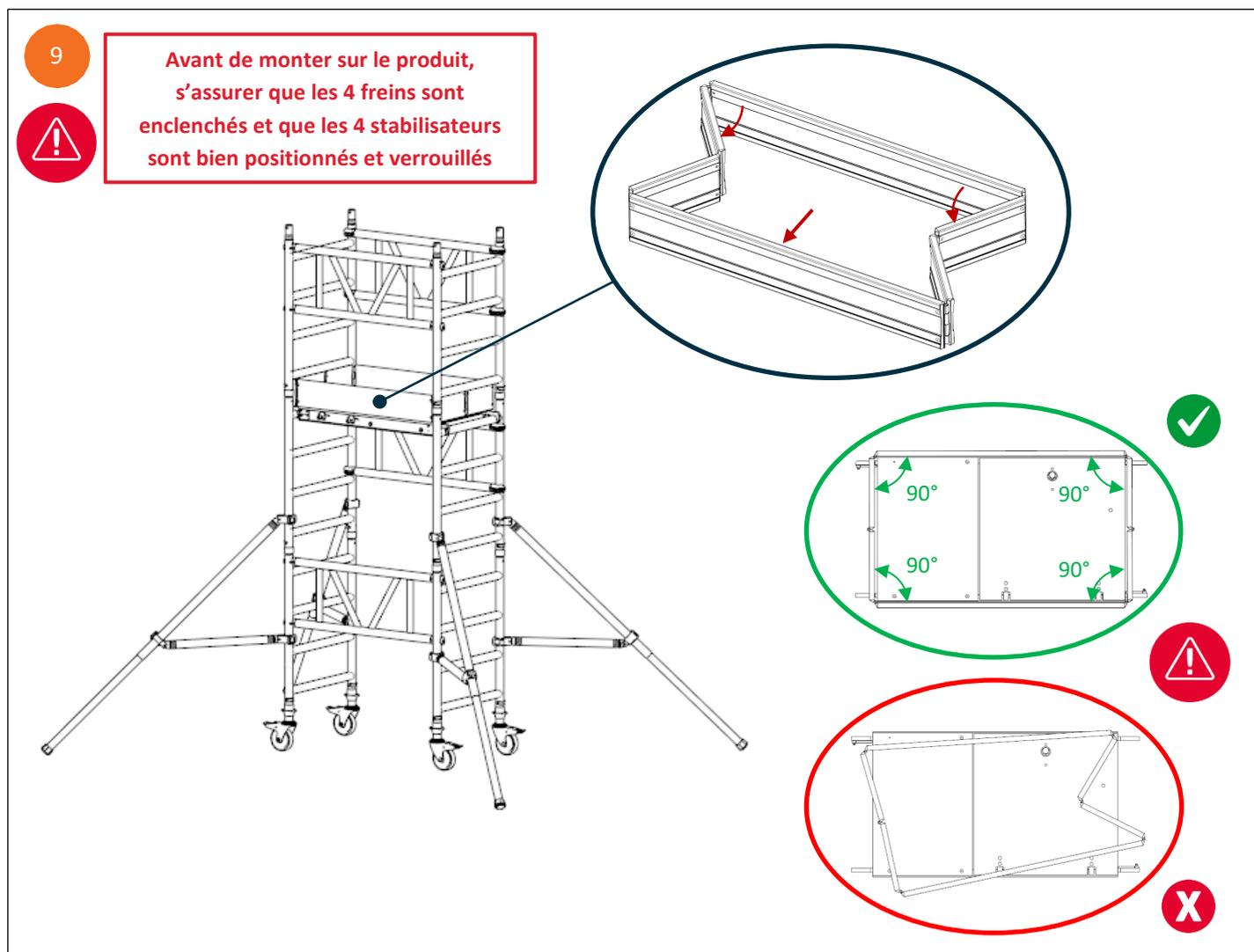
Le produit est prêt à être utilisé à une hauteur de 2.2m.
