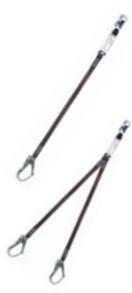
Longes rétractables anti-chute permettant de faciliter les déplacements : longueur rétractée 1,35 m et longueur allongée 1,70 m. Équipées d'un absorbeur d'énergie pour réduire la force de choc en cas de chute. Connecteurs du point d'ancrage Ø 54 mm à fermeture automatique. Connecteurs du harnais Ø 18 mm à fermeture automatique (longes simples et doubles).
