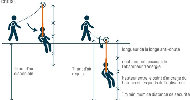
**Le tirant d'air disponible** est la distance entre la structure sur laquelle travaille l'utilisateur et l'obstacle le plus proche.
