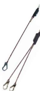
Longes cordes gainées tressées en polyamide. S'utilisent lors d'un risque de chute. L'absorbeur intégré dissipe l'énergie lors d'une chute et limite ainsi la force de choc ressentie par l'utilisateur. Connecteurs du point d'ancrage Ø 54 mm à fermeture automatique. Connecteurs du harnais Ø 18 mm à fermeture automatique (longes simples et doubles).
