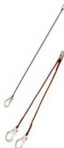
Longes cordes gainées tressées en polyamide. Limitent les déplacements de l'utilisateur et lui interdisent d'approcher de zones à risque de chute. Ceci est un dispositif de retenue et non d'anti-chute. Connecteurs du point d'ancrage Ø 54 mm à fermeture automatique. Connecteur du harnais Ø 16 mm (longes simples) à fermeture manuelle à vis et Ø 18 mm à fermeture automatique (longe double).
