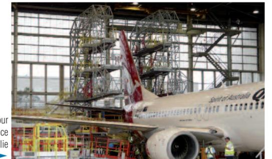
Réalisation sur mesure pour intervention de maintenance d’avions en Australie
