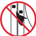
Vérifier que l'échelon du plan intermédiaire repose bien sur le basculeur avant de monter
