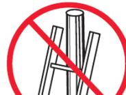
Ne pas appuyer l'échelle contre un poteau, utiliser dans ce cas un berceau d'appui
