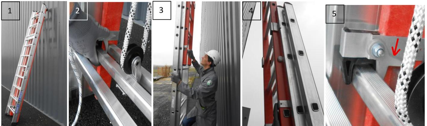
Poser l'échelle Isolex non dépliée à l'emplacement voulu, roues contre le mur (1). Déployer le plan supérieur, déverrouiller la patte d'accrochage (2) et lever le plan supérieur (3). Une butée blanche indique la hauteur maximum de déploiement (4). Une fois posée sur l'échelon, la patte d'accrochage doit être remise manuellement en appuyant à l'endroit indiqué (5).
