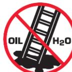
L'échelle doit être dressée sur une surface non glissante
