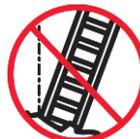
L'échelle doit être dressée sur une surface plane
