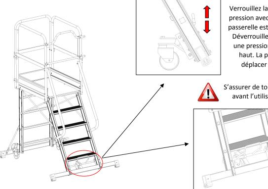
Verrouillez la roue en exerçant une pression avec le pied vers le bas. La passerelle est en position de travail. Déverrouiller la roue en exerçant une pression avec le pied vers le haut. La passerelle peut être déplacer en toute sécurité.
