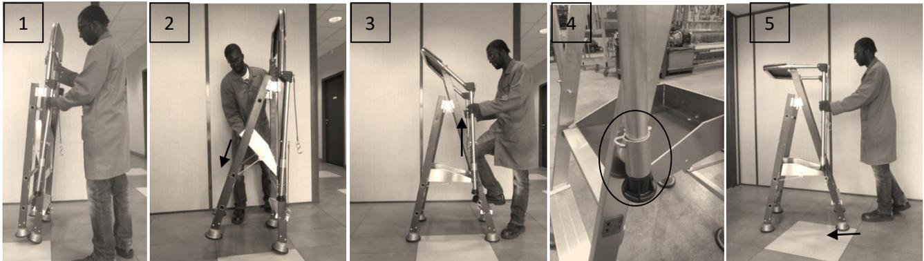
Ouvrir le produit en abaissant la plate forme (2), puis tirer sur les poteaux verticaux (3) jusqu'à ce que le sabot soit en butée, enclenchez alors les verrous. Assurez vous que les poteaux sont verrouillés en tirant dessus vers le bas (4).
