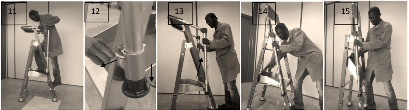
Tirer sur les deux verrous, les pivoter pour qu'ils appuient sur le coulisseau (12), abaisser les poteaux (13), soulever la plateforme (14) et la tirer jusqu'à la position replier (15)
