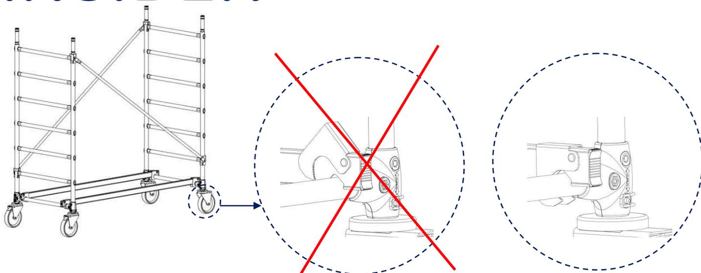
Vérifier que l'échafaudage soit bien de niveau aussi bien dans le sens horizontal que dans le sens vertical. Pour le mettre de niveau utiliser le réglage en hauteur des roues et un niveau à bulle.
