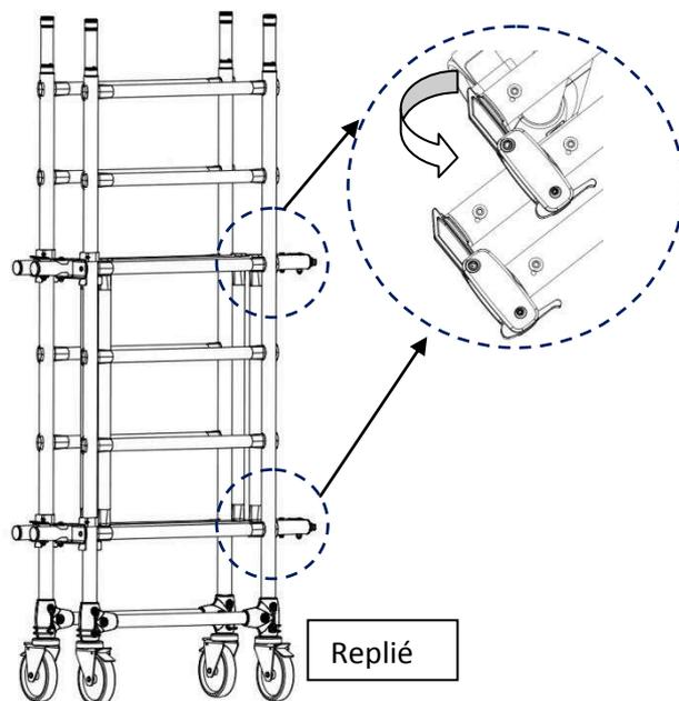
Vérifier que l'échafaudage soit bien de niveau aussi bien dans le sens horizontal que dans le sens vertical. Pour le mettre de niveau utiliser le réglage en hauteur des roues et un niveau à bulle.
