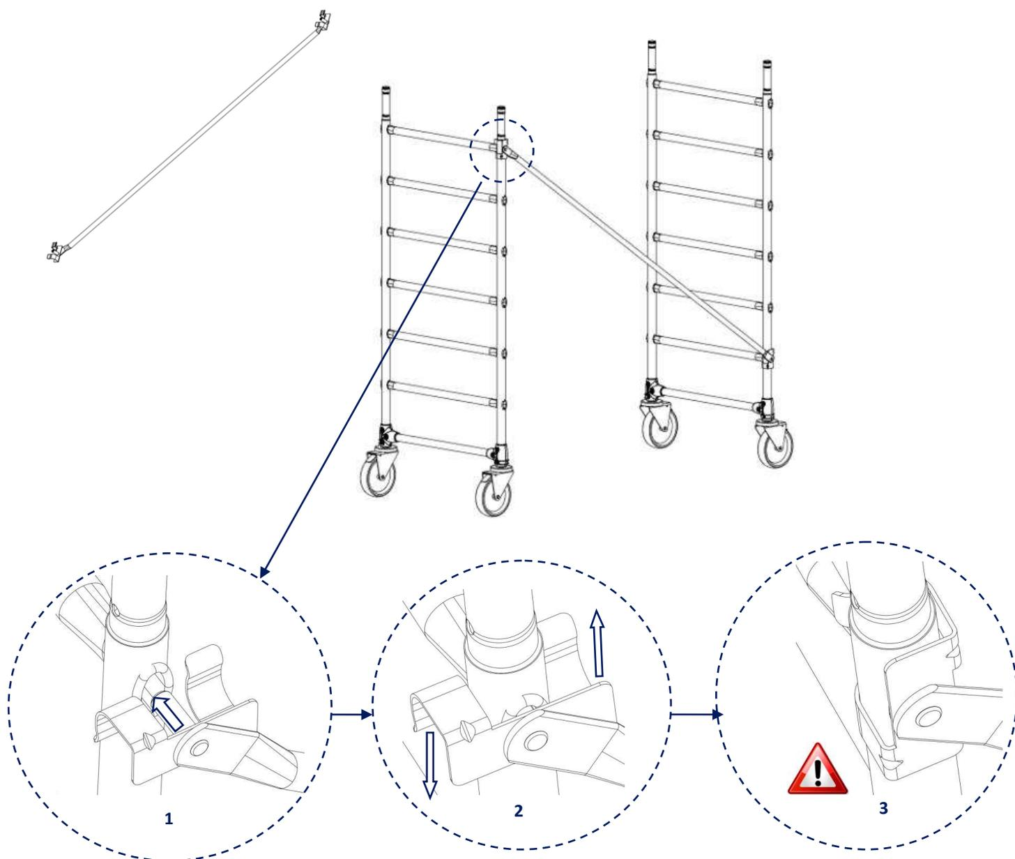
Relier les deux échelles de base par deux lisses placées à l'intérieur de chaque montant, et refermer les crochets:
