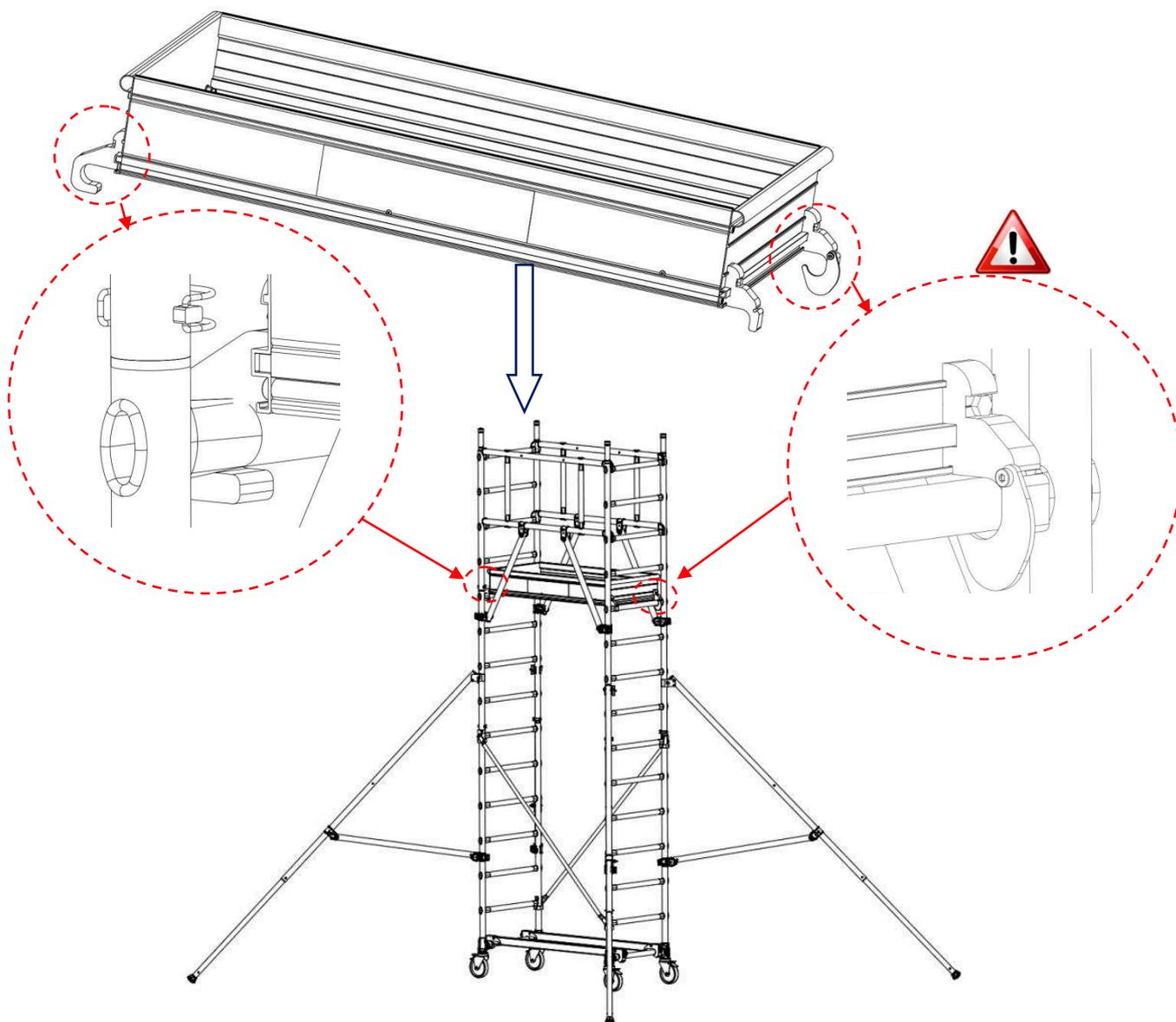
Monter alors les plinthes autour de ce plancher, en commençant par celles d'extrémité(1), puis en y emboitant les latérales (2).
