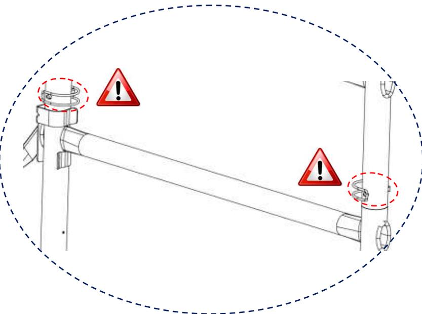
Mise en place des stabilisateurs, serrés sur les montants à l'aide des deux pinces.
