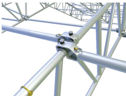
Lorsque l'on doit placer des barres horizontales pour relier des travées pré-bâchées ou les enlever ultérieurement. On peut les placer sur le dessous de la membrure supérieure, avec les plots tournés vers le bas. Ceci doit être vérifié par une personne qualifiée car dans certaines applications à charge élevée. Il est parfois nécessaire de placer des paires de plots ronds pour supporter le rail.
