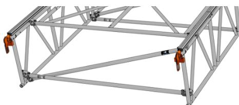
Installer des barres de roulement sur les index d'extrémité de rail et dans les douilles des poutres faîtières pour permettre l'installation des bâches. Des index d'extrémités de rail possèdent des douilles intégrées de chaque côté de la poignée dans lesquelles la barre de roulement doit se placer.
