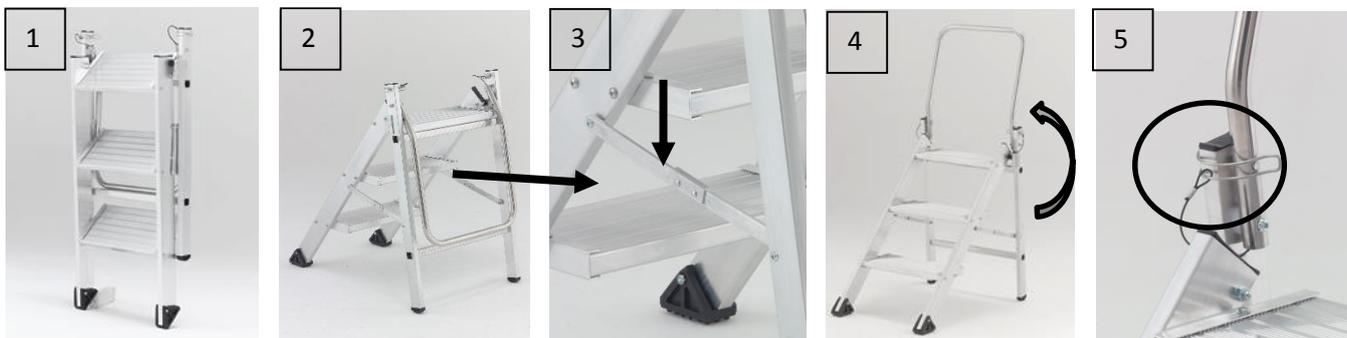
Déplier le produit (2). Vérifier que les deux compas soit en position déployée (3), ne pas hésiter à appuyer dessus. Déplier le garde-corps (4). Mettre les 2 goupilles de fixation au travers des montants et du garde-corps et refermer les clips de celle-ci (5) pour éviter que celui ne se replie.
