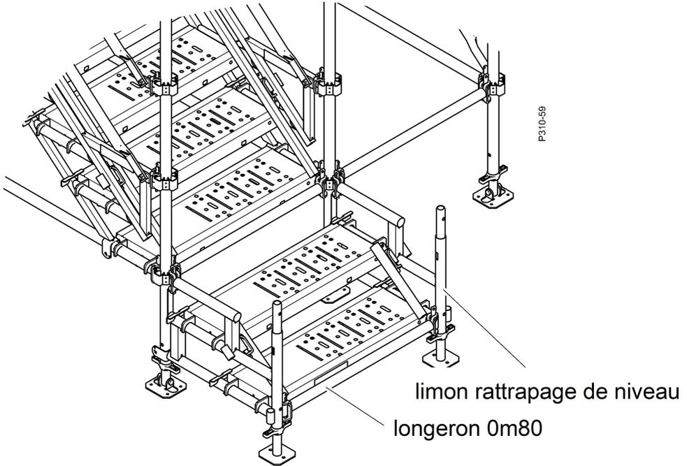
*Configuration 2 : limon monté bout de palier pour redescendre de 0m50*
