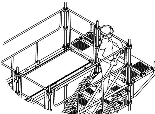
**16** Protéger par les garde-corps provisoires, installer les montants 1m et 0,5 m sur les consoles
