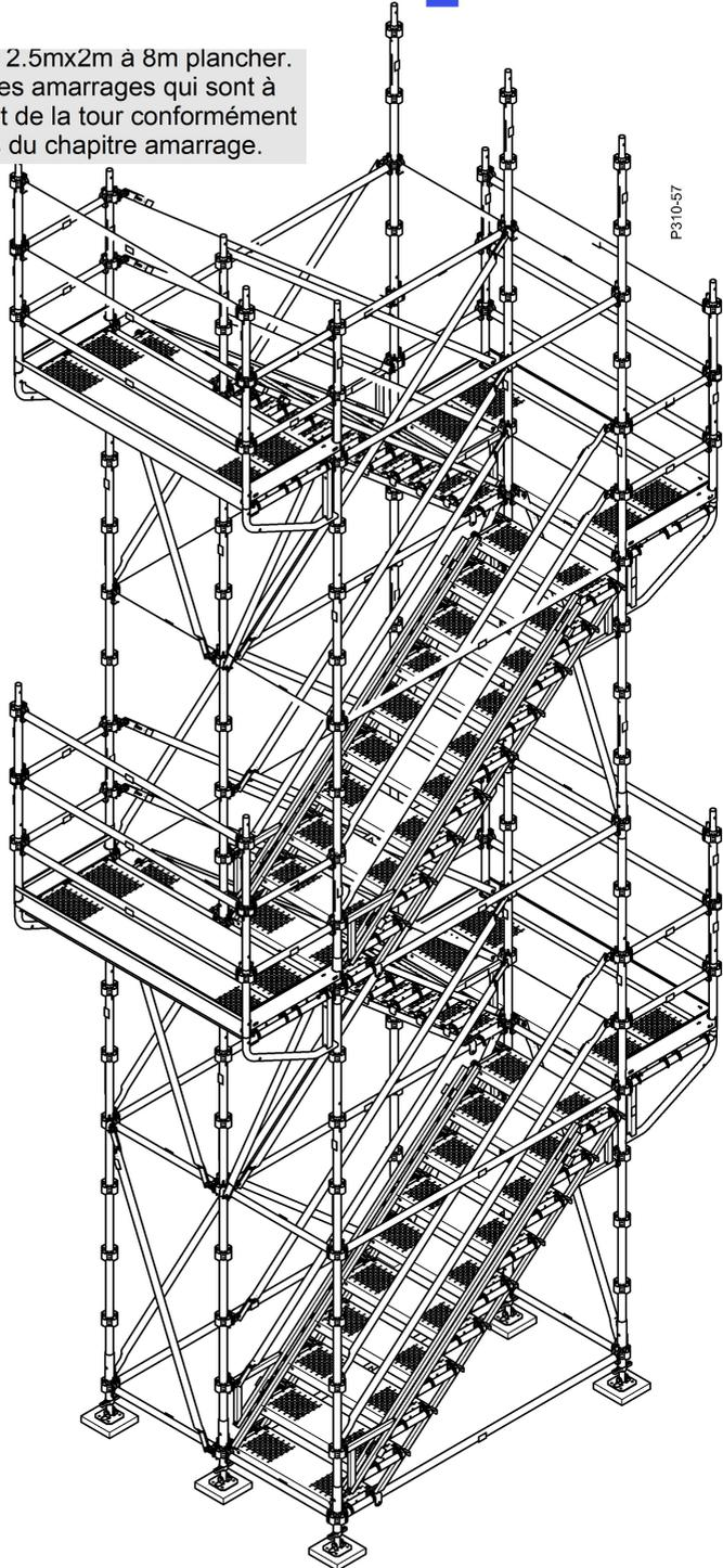
Ce limon permet de monter 5 marches soit 1m de hauteur dans une maille de 2m50.
