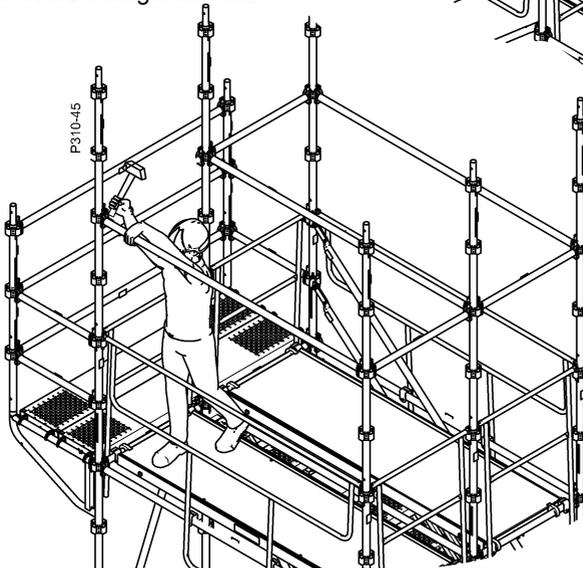
**20** Démontez les 2 garde-corps provisoires d'extrémité ...
