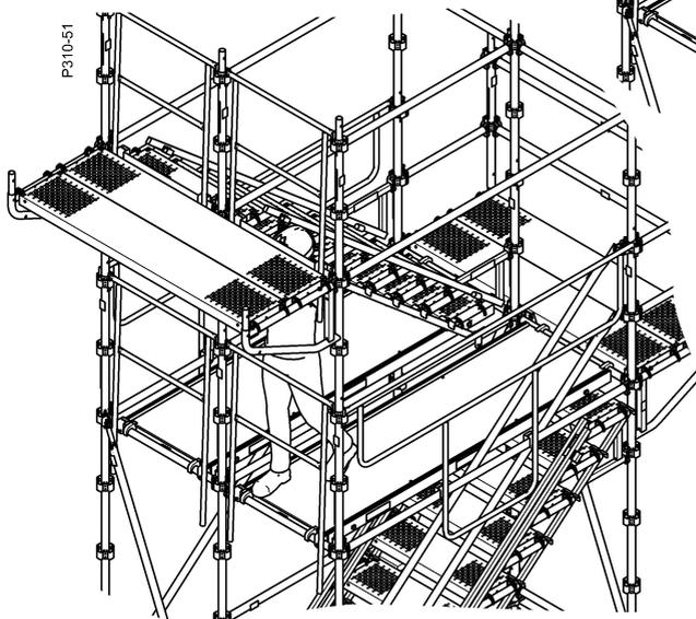
**26** Enlever le plateau d'aide au montage situé entre les limons et le remonter au niveau supérieur (A) . Mettre en place la 1ère marche de l'escalier (B) , puis verrouiller les plateaux avec les barres de blocage (C) . Le 2ème opérateur démonte les 2 garde-corps provisoires d'extrémité du niveau inférieur. Il les fait passer à l'opérateur du dessus qui les installe au niveau supérieur (D) .
