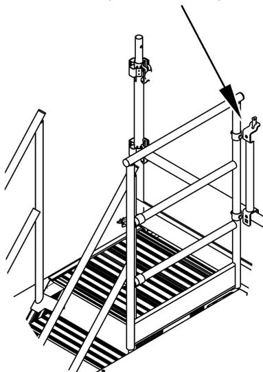
Le montage de la tour accolée au multi se fait en utilisant les 2 files de poteaux communes aux 2 structures. Déposer les garde-corps de sécurité de l'échafaudage, au fur et à mesure du montage.
